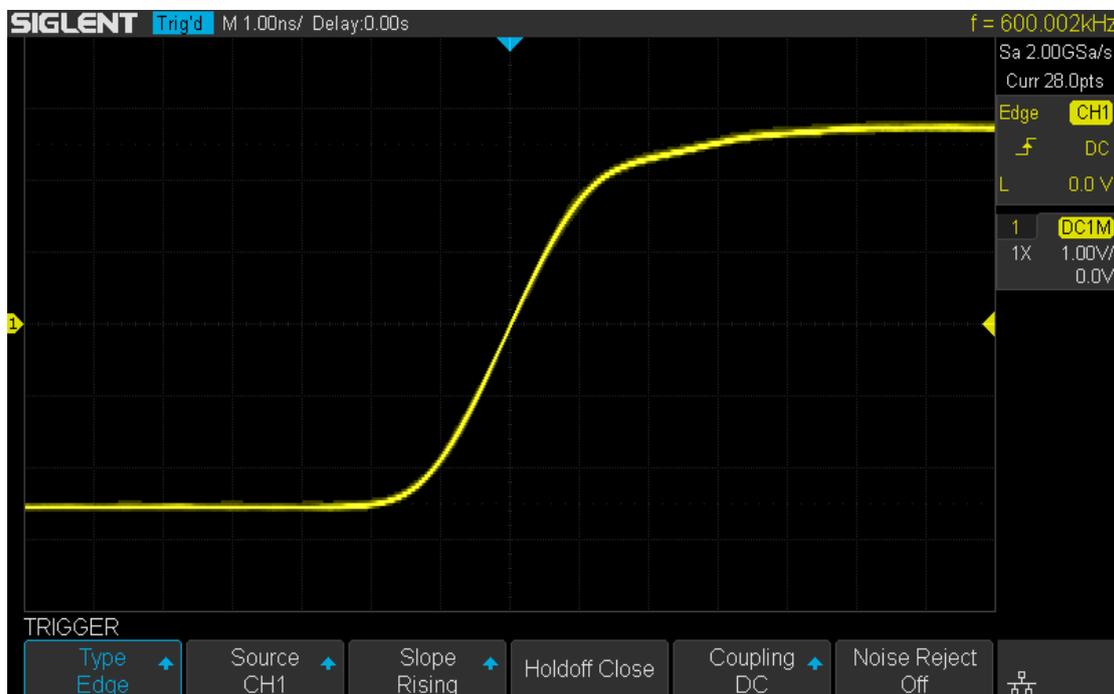
Figure 24 Edge Trigger
